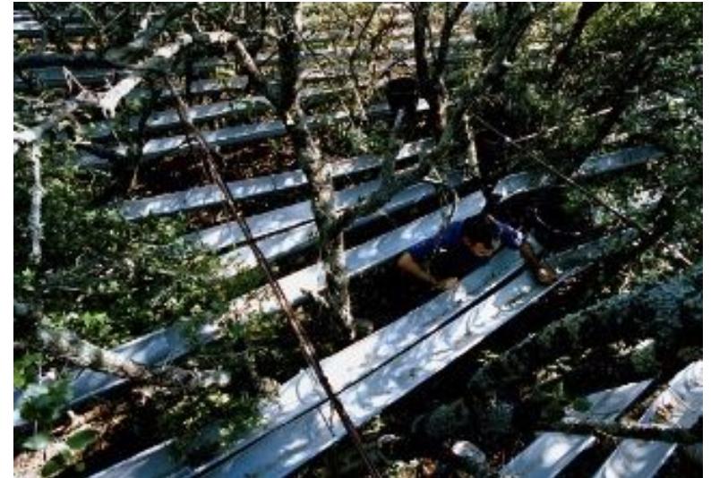
Réponse de la forêt aux sécheresses extrêmes - Système d'exclusion des pluies
